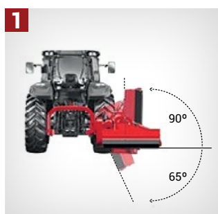
1 VERTIKALNO POMERANJE Od -65° do +90°
