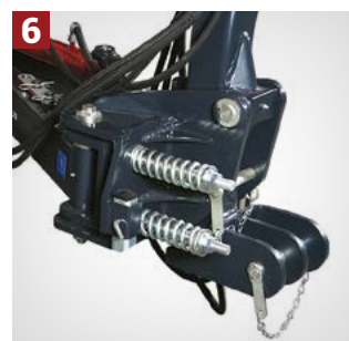
6 SIGURNOSNI MEHANIZAM sa oprugama, omogućava u naletu na prepreku trenutni pomak bočnog mulčara. Time je omogućen siguran prelaz preko prepreke
