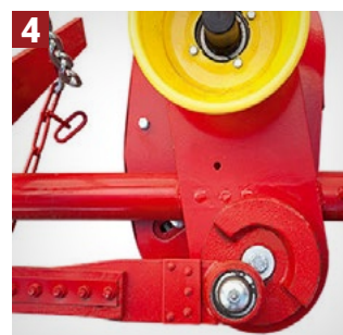
RAMNA KONSTRUKCIJA sigurnosni sistem za automatsko oslobađanje reznog aparata u slučaju nailaska na prepreku
