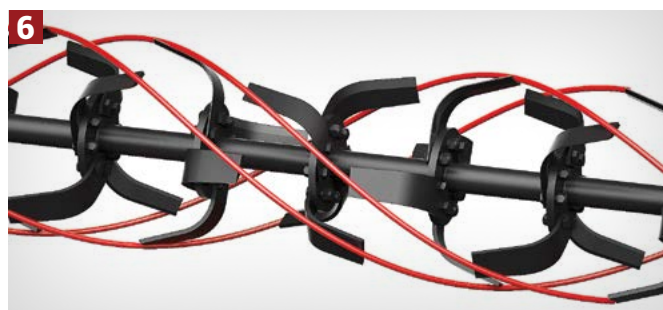
6 SPECIJALNI OBLIK ROTORA Sa spiralnim rasporedom motičica koji omogućavaju efikasno usitnjavanje zemljišta uz minimalan utrošak energije
