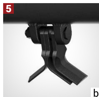
5 OPCIJE NOŽEVA a) Čekić-nož (standardni) – za teže radne uslove (granje, deblji korov, trava i slično); b) Univerzalni Y nož (opcija) – za lakše radne uslove (trava, korov i slično)
