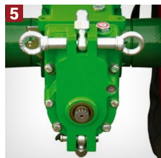
5 IZLAZNO VRATILO za pogon priključaka, nezavisno, do 825 o/min.
