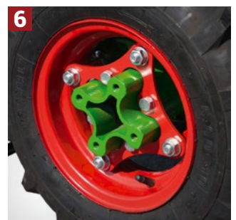
6 DODATNI PAR TOČKOVA se može montirati
