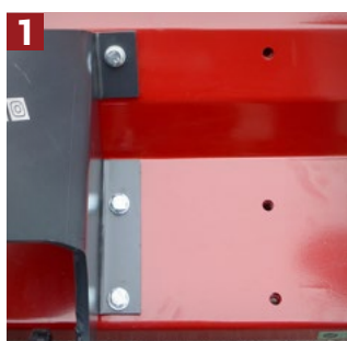
PRIKLJUČNI RAM mogućnost bočnog pomeranja u dva položaja
