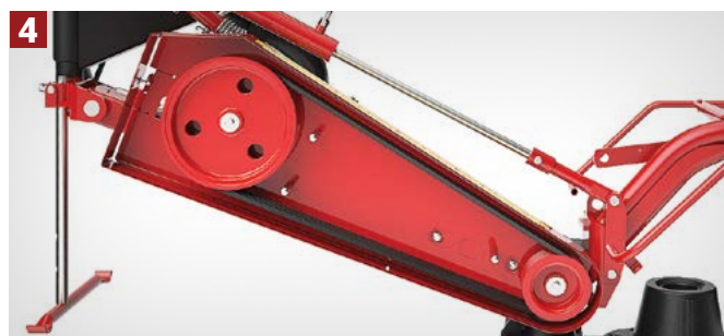
4 SET KLINASTIH KAIŠEVA: prenosi snagu od pogonskog vratila do multiplikatora
