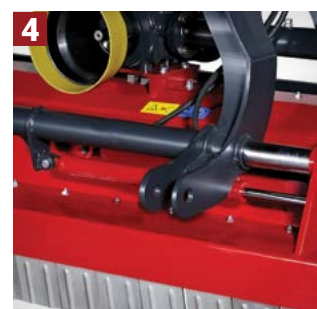
4 HIDRAULIČNO pomeranje u stranu
