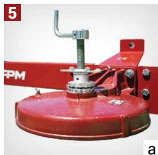
5 PODEŠAVANJE VISINE RADA: a) podešavanjem visine preko kinematske glave;
